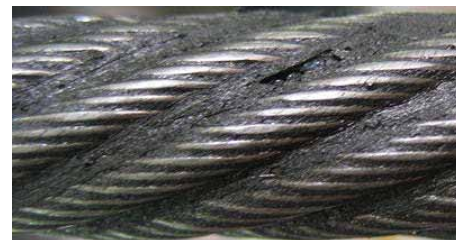
Левая свивка — вращение против часовой стрелки
